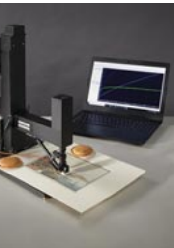
Mittels Micro Fading Testing wird die Ausstellungsdauer eines Objekts bestimmt.
